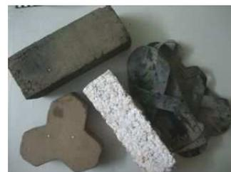
La même entreprise transforme les papiers et cartons en briquettes combustibles. C'est une valorisation simple et logique d'un déchet qui autrement est incinéré alors même que le pays connaît une crise du combustible. La briquette est fabriquée après macération dans l'eau, moulage et séchage des papiers et cartons. On peut aussi fabriquer des briquettes combustibles avec n'importe quel type de déchet organiques, essentiellement les résidus agricoles.
