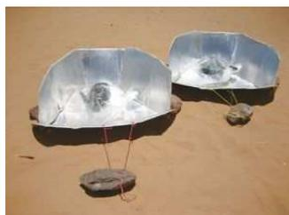
Le cuiseur solaire permet de cuire les aliments avec les rayons du soleil : des panneaux réflecteurs concentrent les rayons sur le plat à cuire. En contexte de pénurie de bois, c'est donc une alternative à la cuisson par la combustion du bois. Le modèle *Cookit* est constitué de matériaux basiques. Il n'est pas le plus efficace des cuiseurs solaires, mais il est fabricable dans les camps et à un prix modique.
